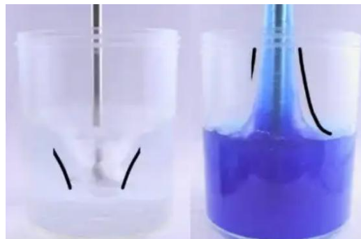
图 4.1 黏弹性流体的爬杆效应（旋转金属棒，左边流体为牛顿流体，右边流体为黏弹性流体）
